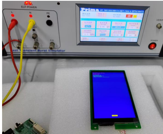
图 5-4 群脉冲测试图
