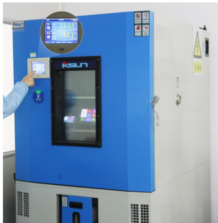
图 5-3 高低温老化测试图
